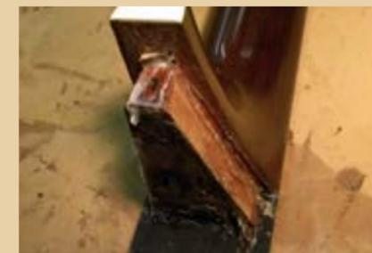
Ansicht eines Schwalbenschwanz-Halses mit Leimresten nach dem Abnehmen des Halses. Um den Halswinkel zu verändern, muss stellenweise Holz abgetragen und an anderen Stellen hinzugefügt werden.
