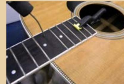
Nachdem ein Bundstab entfernt wurde, wird durch ein Loch im Bundschlitz Dampf in die Schwalbenschwanz-Halsverbindung eingeleitet, damit der Leim weich wird und sich löst.
