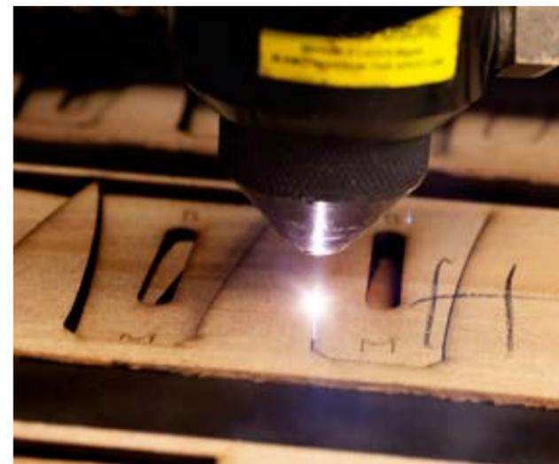
V. o. n. u.: Ein Halsfuß wird von einer CNC-Fräse geformt; Halswinkel-Abstandhalter werden lasergeschnitten.
