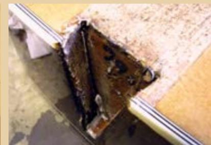
Schwalbenschwanz-Halsverbindung mit Leimresten nach dem Abnehmen des Halses.
