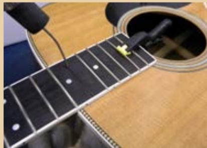
Dopo la rimozione di un tasto, la colla dell'incastro a coda di rondine viene ammorbidita e poi sciolta immettendo vapore dall'alloggiamento del tasto.
