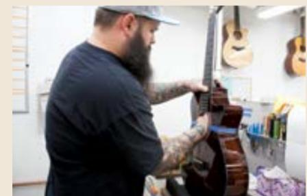
Il manico viene agevolmente riassetto dal foro di risonanza tramite un fissaggio sicuro a tre viti.
