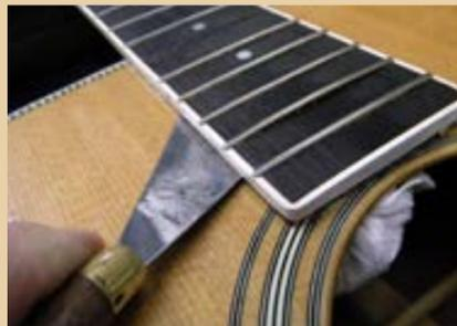
Il prolungamento della tastiera viene separato dal top utilizzando una speciale spatola per la rimozione di ponti e tastiere.
