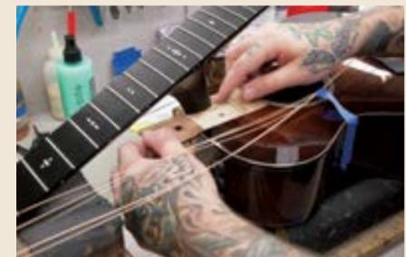
Sostituzione di un distanziatore di precisione con un altro di spessore infinitesimamente diverso per modificare l'inclinazione.
