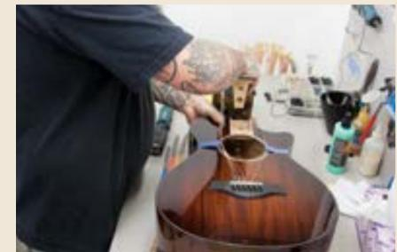
La rimozione di un manico Taylor è talmente semplice che, per regolare l'inclinazione del manico, le corde vanno semplicemente allentate.
