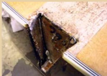
Mortasa di un incastro a coda di rondine e residui di colla dopo la rimozione del manico.
