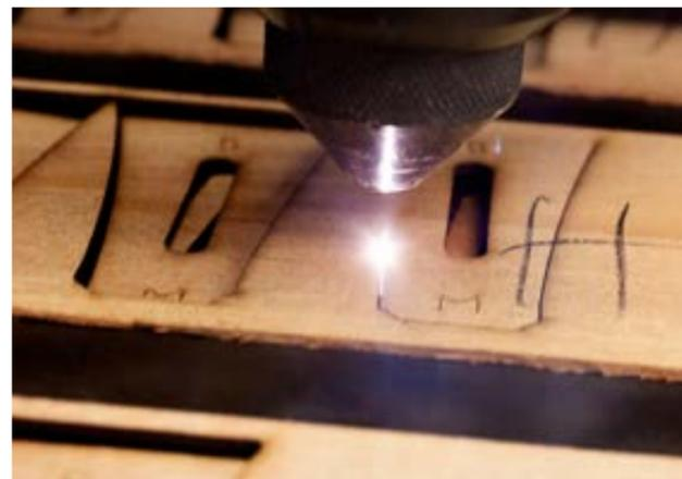
**Dall'alto in basso:** il tacco del manico viene modellato con fresatura CNC; taglio laser dei distanziali per l'inclinazione del manico
