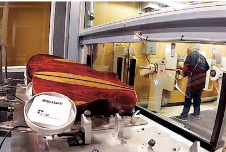
Tiroirs à palette où les corps sont installés pour le polissage. Le boîtier rond contient un lecteur RFID
