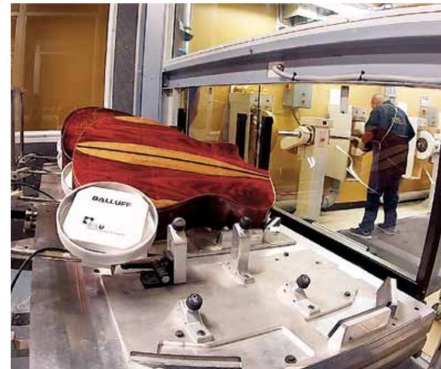
I cassetti di legno dove vengono messi i corpi per la lucidatura. Il rivestimento ha un'identificazione a radiofrequenza
