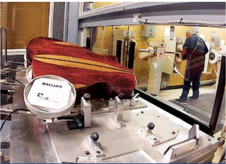
Palés donde se cargan las cajas acústicas/cuerpos de guitarra para su posterior pulido. La carcasa redonda contiene un escáner lector de radio-frecuencia.
