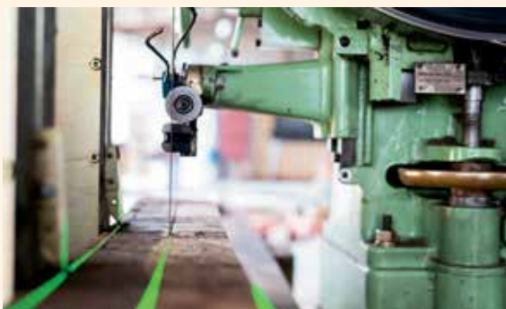
Les guides laser aident les scieurs à pratiquer des coupes plus précises
