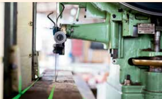
Le guide al laser aiutano i segantini a fare tagli più precisi
