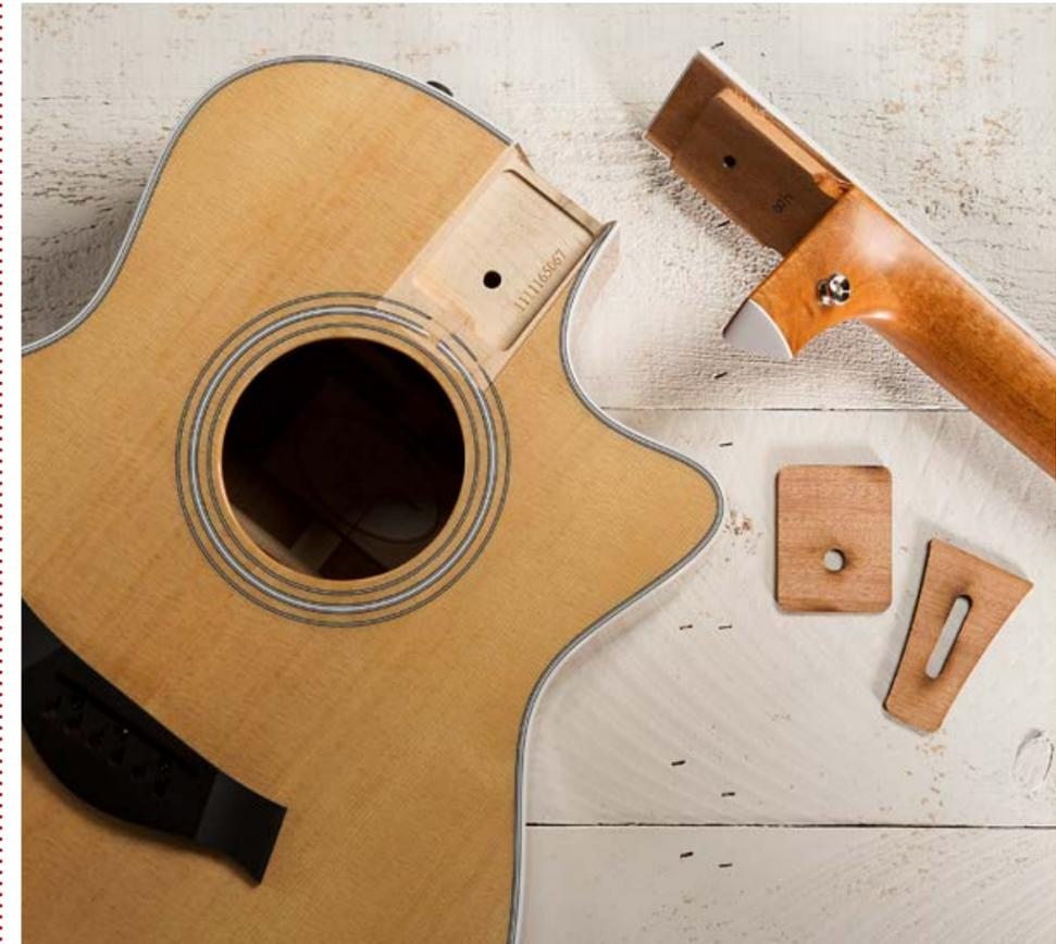
Wie zuvor bereits erwähnt, bestimmt der Halswinkel, besonders des von Taylor patentierten Halsdesigns, die Geometrie zwischen Hals und Korpus der Gitarre. Eine Veränderung des Halswinkels beeinflusst die Steifheit der Decke und damit deren Reaktion auf die Saitenschwingungen. Dies wirkt sich auf verschiedene Weise auf das Spielerlebnis aus, wie Andy erklärt.
