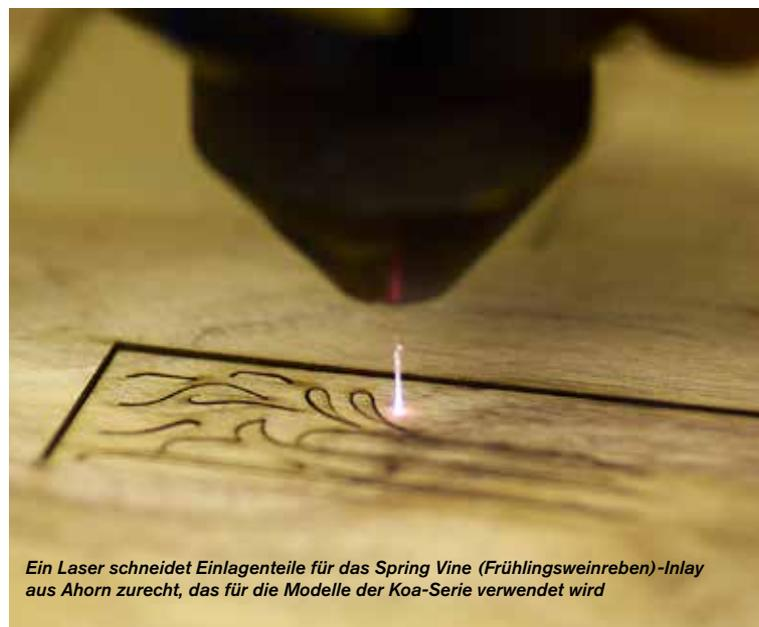
Ein Laser schneidet Einlagenteile für das Spring Vine (Frühlingsweiden)-Inlay aus Ahorn zurecht, das für die Modelle der Koa-Serie verwendet wird
