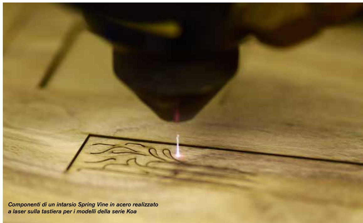
Componenti di un intarsio Spring Vine in acero realizzato a laser sulla tastiera per i modelli della serie Koa
