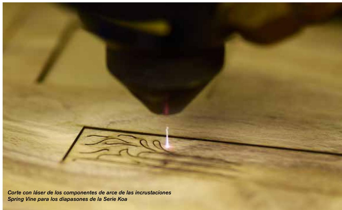
Corte con láser de los componentes de arce de las incrustaciones Spring Vine para los diapasones de la Serie Koa
