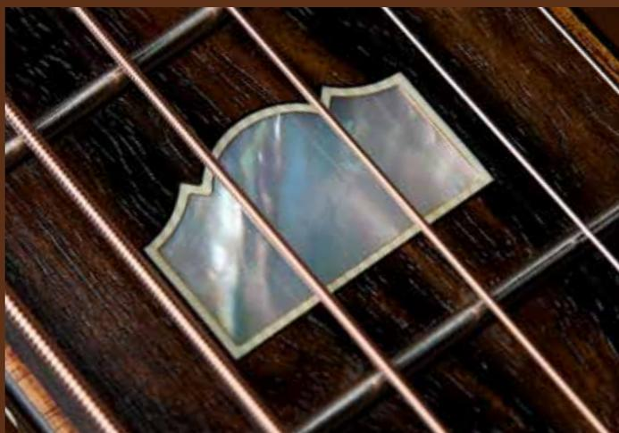
«Hay que tener en cuenta que, aunque estés cortando con una herramienta dirigida por ordenador, no hay manera de perfilar una esquina interior con un ángulo muy agudo usando un cortador redondo. En cambio, si trabajas a mano al estilo tradicional si es posible conseguir esa definición, porque con una hoja de sierra los cortes agudos quedan bien rectos. Las máquinas CNC siempre dejarán como mínimo el pequeño radio correspondiente al cortador».
